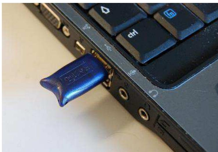
Figura 9 – Inserzione della chiave di protezione nella porta USB del computer
