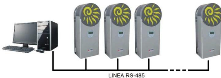
Nel caso di più inverter collegati ad una singola porta seriale, questi dovranno avere indirizzi differenti. Il controllo, se tecnicamente possibile, è in grado di gestire fino a 255 dispositivi collegati ad una singola linea seriale. Se gli inverter sono invece collegati a più linee seriali, inserire un oggetto per ogni linea.
