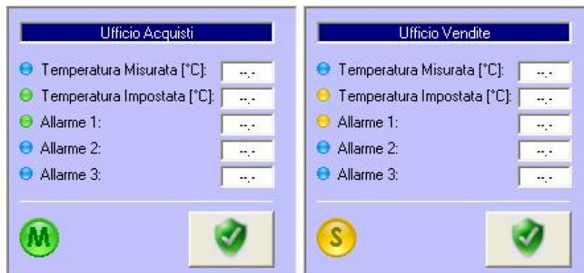
Figure 3.44 e 3.45: Indicatori della funzione Master (di colore verde a sinistra) e slave (di colore giallo a destra).
