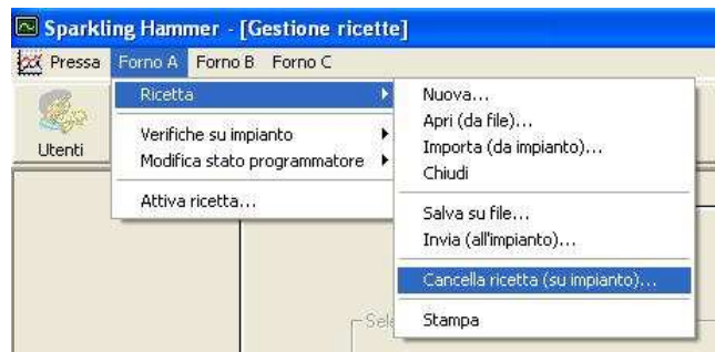
Figura 3.35: Eliminazione di una ricetta dall'impianto
