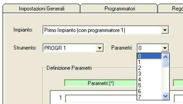
Figura 2.22: Selezione del numero di parametri da inserire
