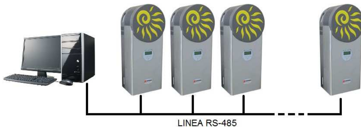
Figura 3.10: Architettura costituita da più inverter dialoganti mediante porta RS485.
