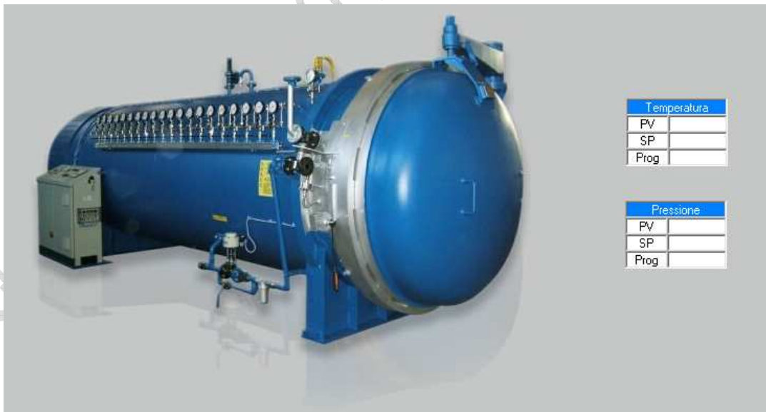
Figura 10: Autoclave dotata di due programmatori per il controllo della temperatura e della pressione.
